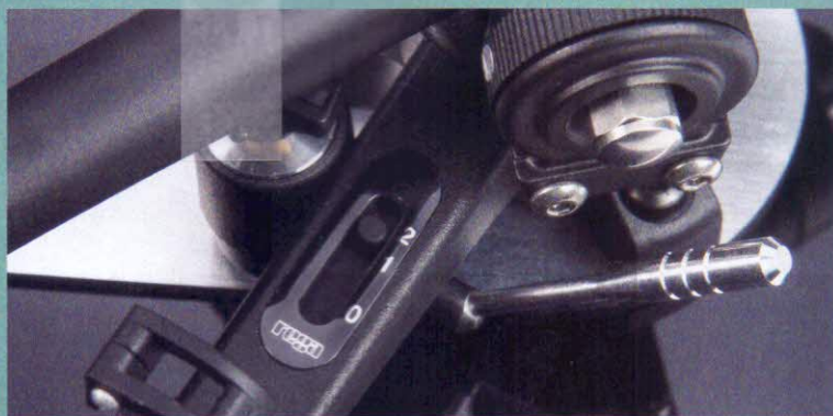
▲ Nach wie vor wird die per Federkraft wirkende Antiskating über einen kleinen Schieber eingestellt, doch die Skala fällt jetzt hübscher aus.
