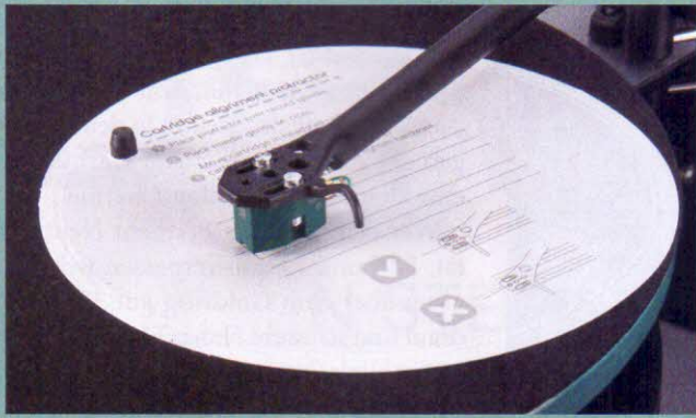
▲ Mit Hilfe der Linien auf der beige packten Pappschablone gelingt auch Laien die Tonabnehmerjustage.
