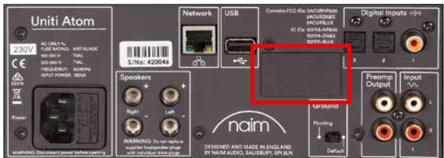
▲ Via Preamp-Out kann man sogar einen Subwoofer oder Endstufen antreiben. Die schwarze Klappe in der Gehäusemitte (Rahmen) kann einen optionalen HDMI-Eingang aufnehmen.
