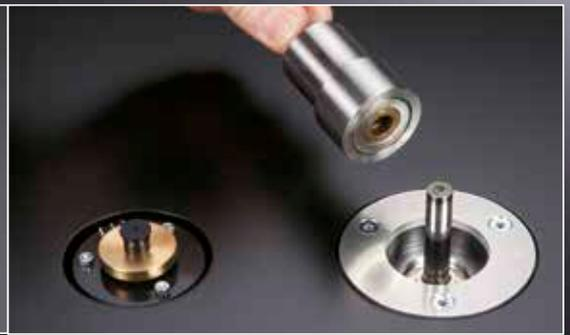
▲ Das inverse Tellerlager sorgt für einen tiefen Schwerpunkt und damit für Stabilität. Es besteht aus einem Edelstahlhorn mit harter Rubinkugel. Das Gegenstück bildet die Lagerbuchse aus Sinterbronze plus Saphirspiegel. Ringe aus Neodymmagneten verringern durch Abstoßung den Lagerdruck auf ein Zehntel.
